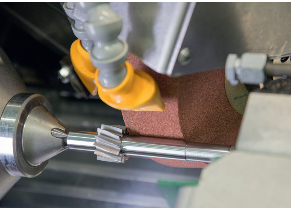
1 Schleifen im Sinne der Komplettbearbeitung integriert: Die Hartdrehmaschine MikroTurnGrind 1000 von Hembrug wurde für Schleif-Finishbearbeitung wellenförmiger Bauteile konzipiert (© Hembrug)
