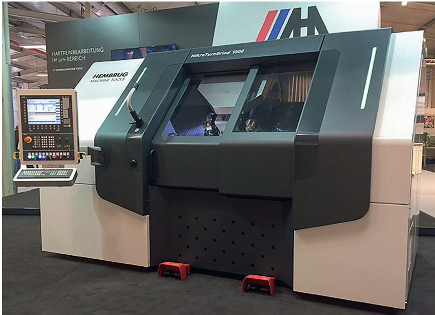
2 Kombinierte Hartfeinbearbeitung: konstruktiv und thermisch stabil ausgeführt, ermöglicht die MikroTurnGrind 1000 das mikrometeregenaue Hart-Vordrehen und Feinschleifen in einer Aufspannung (© Hembrug)
