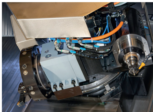
3 Arbeitsraum: Die MikroTurnGrind 1000 trägt einen Revolver mit acht statischen Werkzeugen, eine Außen- und eine Innenschleifspindel; wahlweise kann eine Schleifspindel mit einer Frässpindel ersetzt werden (© Hembrug)
